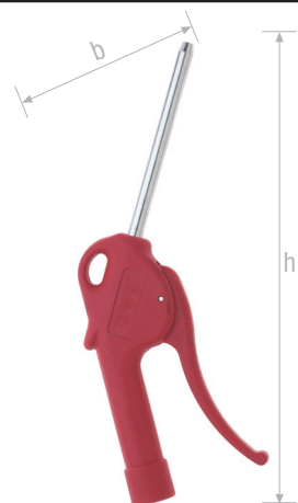
Abblaspistolen aus Kunststoff mit Ausblasedüse, 100 mm lang gerades Rohr, verchromt Düsenöffnung 2,5 mm PN 16 bar
